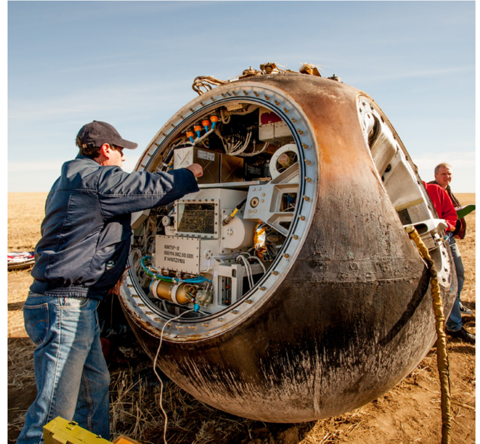
Демонтаж аппаратуры из спускаемого аппарата КА «Фотон-М» после приземления. Фото А. А. Якунина
