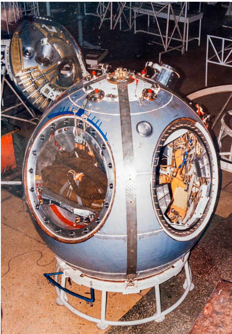
СА изделия «Фотон». Слева парашютная система. Фото АО «РКЦ «Прогресс»
