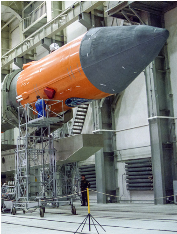
Головной обтекатель ракеты «Молния-М» в МИКе. Фото АО «РКЦ «Прогресс»
